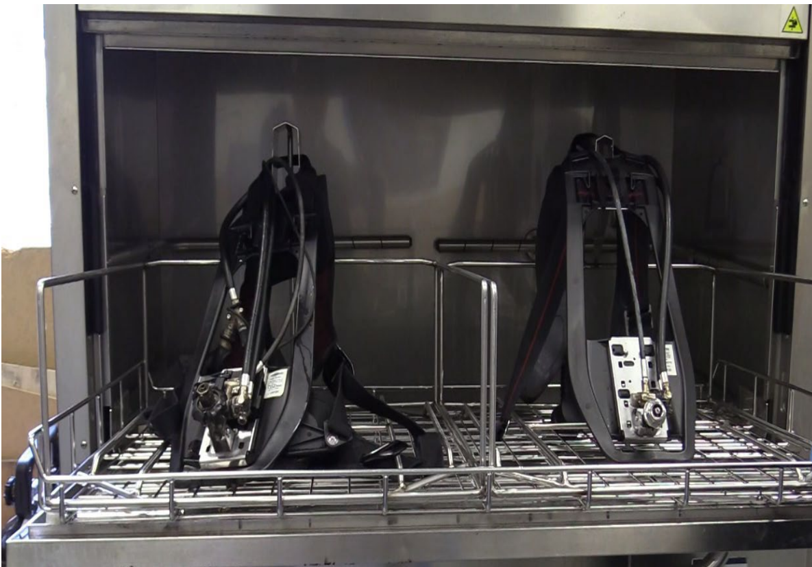
Bild 5. Trageeinrichtung mit angeschlossenen Atemschutzgerät nach Vorbehandlung und Waschen in einer Tank-Spülmaschine mit PPE Decon Cleaner
