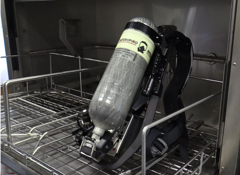
Bild 3 und 4. Atemschutzgerät und Teile der Trageeinrichtung aus Bild 1 und 2 nach Vorbehandlung und Waschen.
