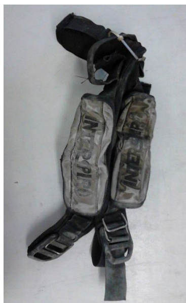
Bilder 1 und 2. Schmutziges und verrußtes Atemschutzgerät und Teil eines Tragegestells vor dem Waschen
